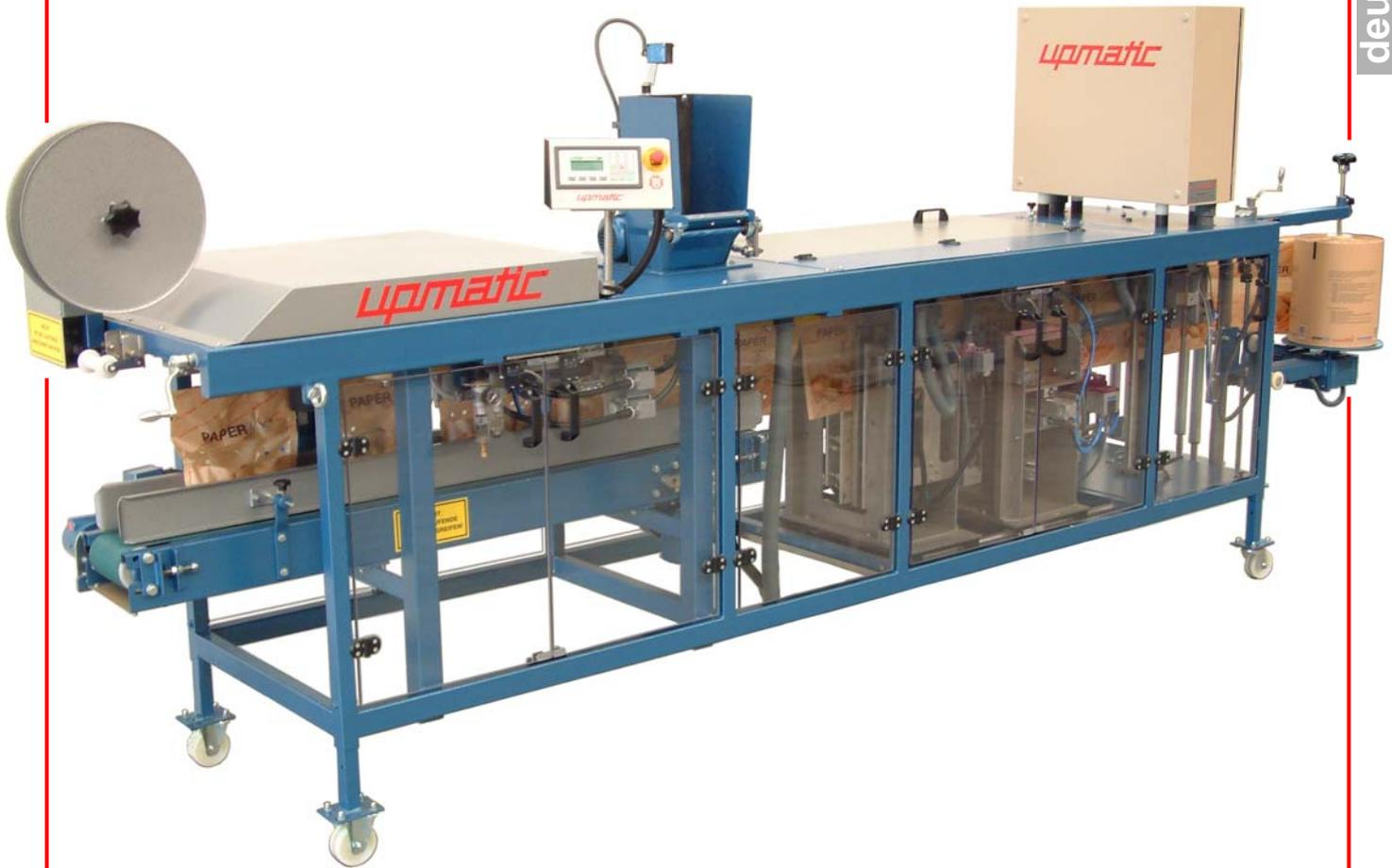
**Upmatic PAPERflex = vollautomatische Füll- und Verschließmaschine für PAPERflex-Beutel von 0,5 bis 5 kg Füllgewicht. Für alle stückigen und körnigen Produkte des Lebensmittel- und des Non-food-Bereichs geeignet.**
