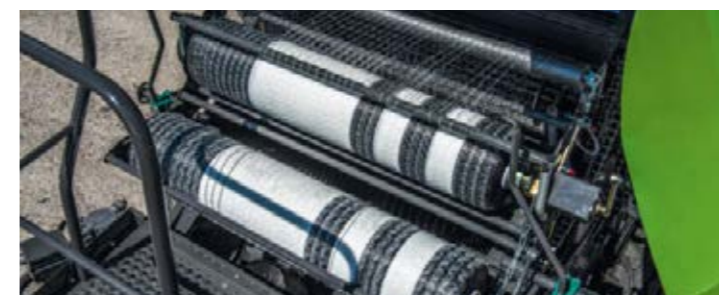
EasyLoadSystem võimaldab võrgurulle lisada kõige lühema ajaga.
