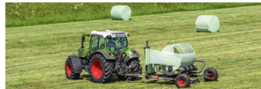
Fendt Rollector kiletab rulle läbimõõduga 0,90–1,30 m.
