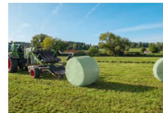
Rollector 160 kiletaja on varustatud lauaga rulli aktiivseks mahaasetamiseks ilma kilet kahjustamata.
