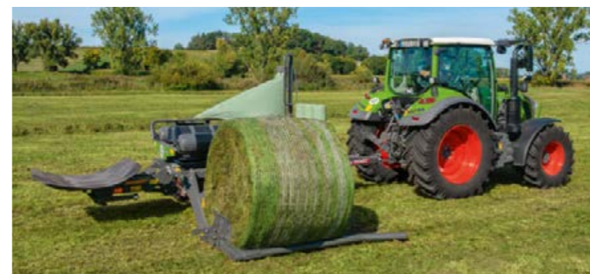
Nii rullitõstjat kui ka kiletuslaua saab reguleerida ühilduvaks erinevate rullisuurustega. Saate ohutult võtta peale 1,25–1,6 m läbimõõduga rullid ja mähkida need õhukindlalt kilesse.
