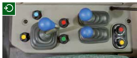
■ Ristlülituskangi abil saate lisahüdraulika 1. ja 2. väljavõtet väga täpselt juhtida
