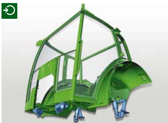
□ Fendt 200 Vario saab varustada täiendava kabiinivedrustusega. Kabiini esiosa toetub kummist koosnedaagritele, mis summutavad traktoriraamilt lähtuvat vibratsiooni. Kabiini taga asuv spiraalvedrudega leevendissüsteem vähendab löökoormused miinimumini.
