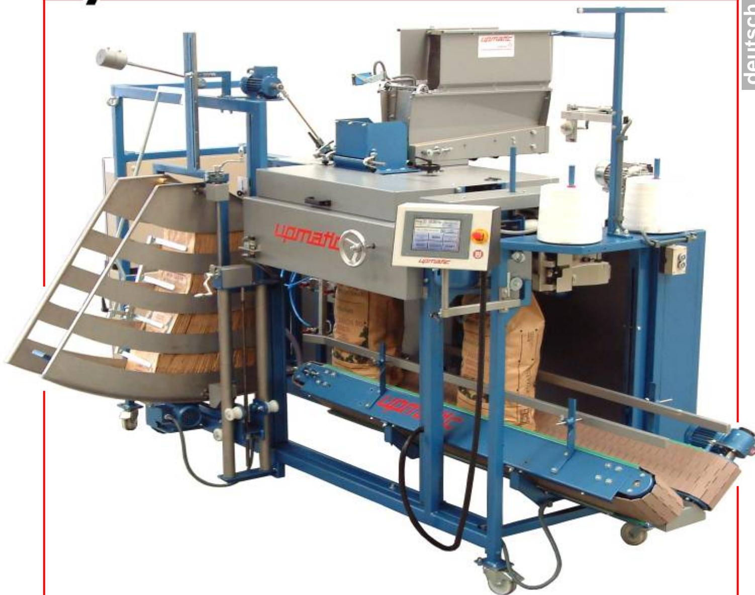
**Upmatic 4125 = vollautomatische Füll- und Verschleißmaschine für Papiertüten mit oder ohne Tragegriff von 5 bis 25 kg Füllgewicht. Geeignet für alle stückigen und körnigen Produkte des Lebensmittel- und des Non-food-Bereichs.**
