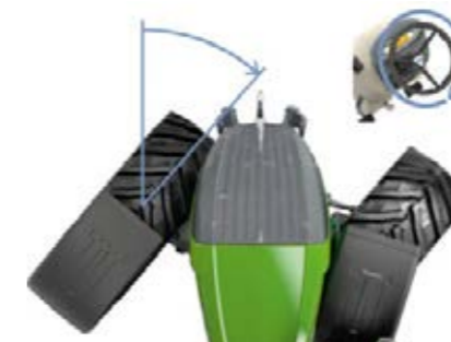
VarioActive aktiivvõimenduse abil saate maksimaalse roolimisnurga ainult rooli ühe täispöördega.
