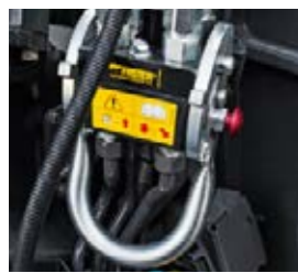
Standardvarustuses kiirliitmik frontaallaaduri kiireks ühendamiseks ja mahavõtmiseks.
